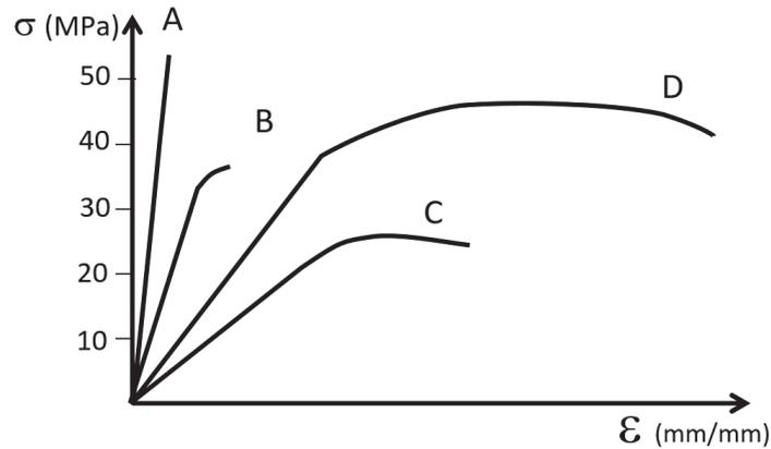
Considerando o gráfico tensão x deformação obtido a partir do ensaio de tração de quatro hipotéticos materiais (A, B, C e D):
