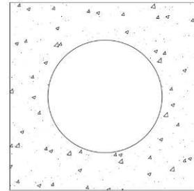
Considere que os coeficientes de ponderação das ações e de amplificação dinâmica de valores sejam iguais a 1,3 e o peso específico do concreto armado igual a 25 kN/m<sup>3</sup>. Assim, o valor aproximado da carga de cálculo estática equivalente mínima a ser indicada para seu içamento é de:
