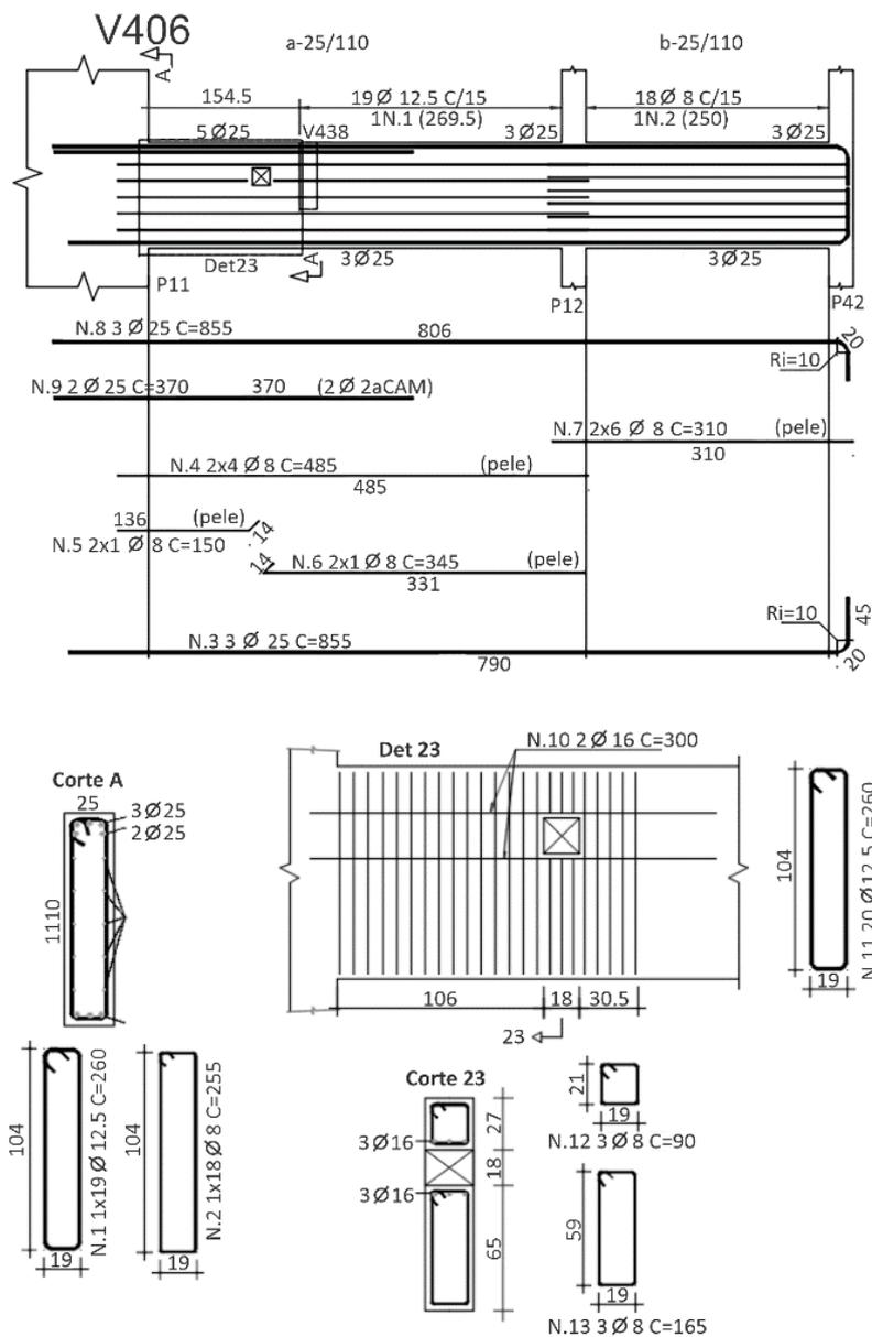
No desenho de detalhamento da viga V406, quais são as posições detalhadas para o equilíbrio do cisalhamento?
