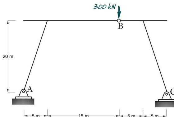
Para o pórtico triarticulado construído para sustentação do trecho de um viaduto, as reações vertical e horizontal (empuxo) em C são, respectivamente,
