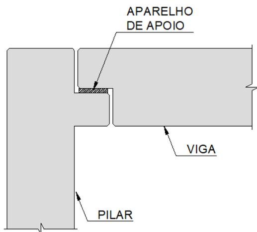
Considerando-se a possibilidade de adição de algum dispositivo anterior ou posterior à montagem da ligação indicada na figura, quanto ao giro da extremidade da viga no plano indicado é correto afirmar:
