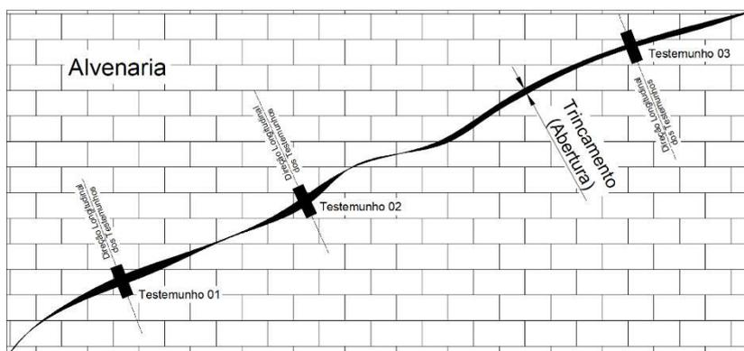
Figura 02 – Disposição de testemunhos em trinca / alvenaria.
