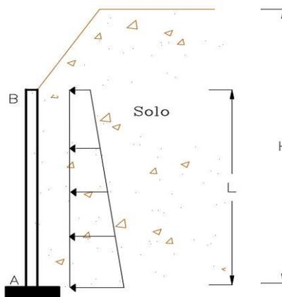
Considere-a como uma viga em balanço no plano. O solo exerce sobre ela uma carga horizontal, contida no plano, com variação linear conforme figura. O valor da carga em A é dado pela relação:
