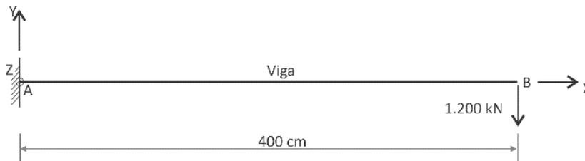
Figura 02 – Viga engastada submetida a carga de 1.200 kN na extremidade (Ponto B). Nota: observe o sistema cartesiano (X, Y, Z) com origem em A.
