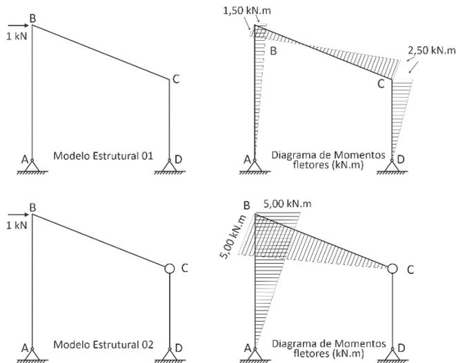
Figura 01 – Modelos estruturais e diagramas de momentos fletores.
