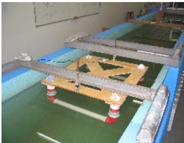
Plataforma semi-submersível sendo testada no tanque de provas do Laboratório de Engenharia Naval e Oceânica da EPUSP
